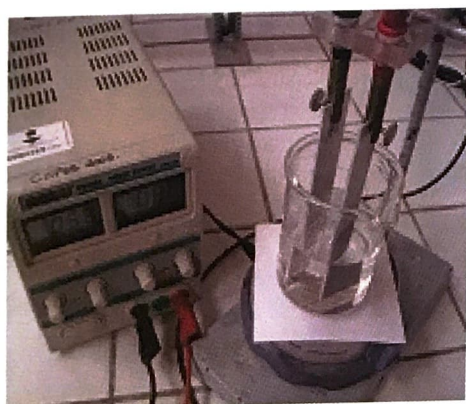
Fig. 3 C.13a : montage pour réaliser l'anodisation d'une lame d'aluminium.
