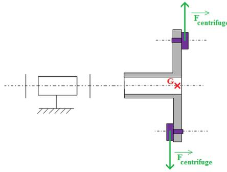
En fait la résultante des forces centrifuges est bien nulle mais elles créent un couple sur l'axe de rotation orthogonal à l'axe et qui a donc tendance à le tordre.
