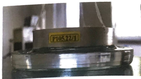
Figure 5 – Photographie du ménisque un peu avant la rupture. On constate que le ménisque est tiré nettement au-dessus de la surface par la présence de l'anneau. Au niveau de la ligne de contact, l'interface s'approche de la verticale.
