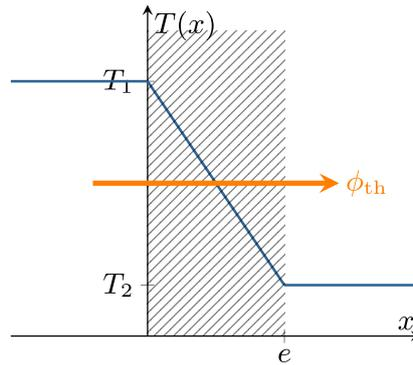
Le champ de température étant déterminé on peut obtenir la densité de courant thermique ainsi que le flux thermique traversant le mur :
