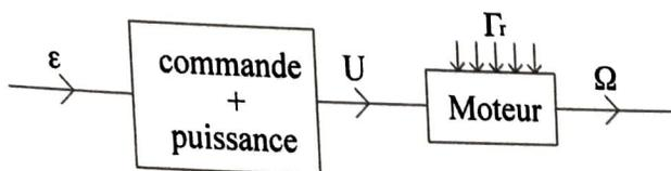
où on a placé en amont du moteur un dispositif de puissance (par exemple un amplificateur de puissance) caractérisé par une relation linéaire et instantanée :
