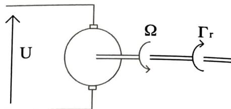
Il s'agit d'un dispositif qui, alimenté sous une tension  $U$  (généralement continue), tourne à la vitesse  $\Omega$  en entraînant éventuellement une charge qui exerce sur l'arbre du moteur un couple résistant  $\Gamma_r$  (que nous compterons positif s'il est réellement résistant).
