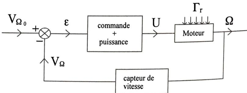
On parle de système bouclé car on soustrait à la grandeur de commande  $V_{\Omega_0}$  une grandeur  $V_{\Omega}$  image de la grandeur de sortie  $\Omega$  :
