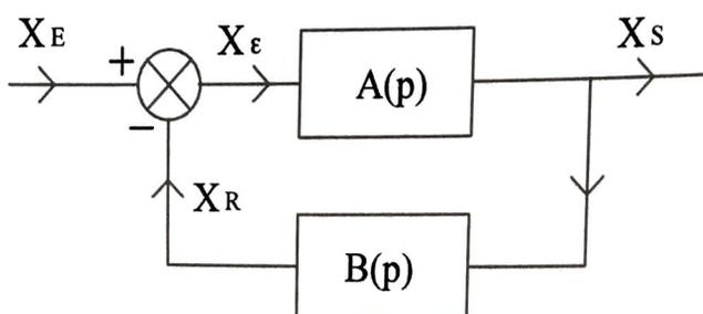
Notons  $H(p)$  la fonction de transfert (en boucle fermée) de l'asservissement schématisé par la figure précédente et  $T(p)$  sa fonction de transfert en boucle ouverte :
