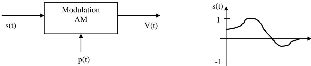
$V(t)$  peut s'écrire sous la forme  $V(t) = V_0 (1 + k s(t)) \cos(2\pi f_0 t)$  avec  $f_0 \gg f_{\text{Max}}$  de  $s(t)$  et  $-1 < k s(t) < 1$
