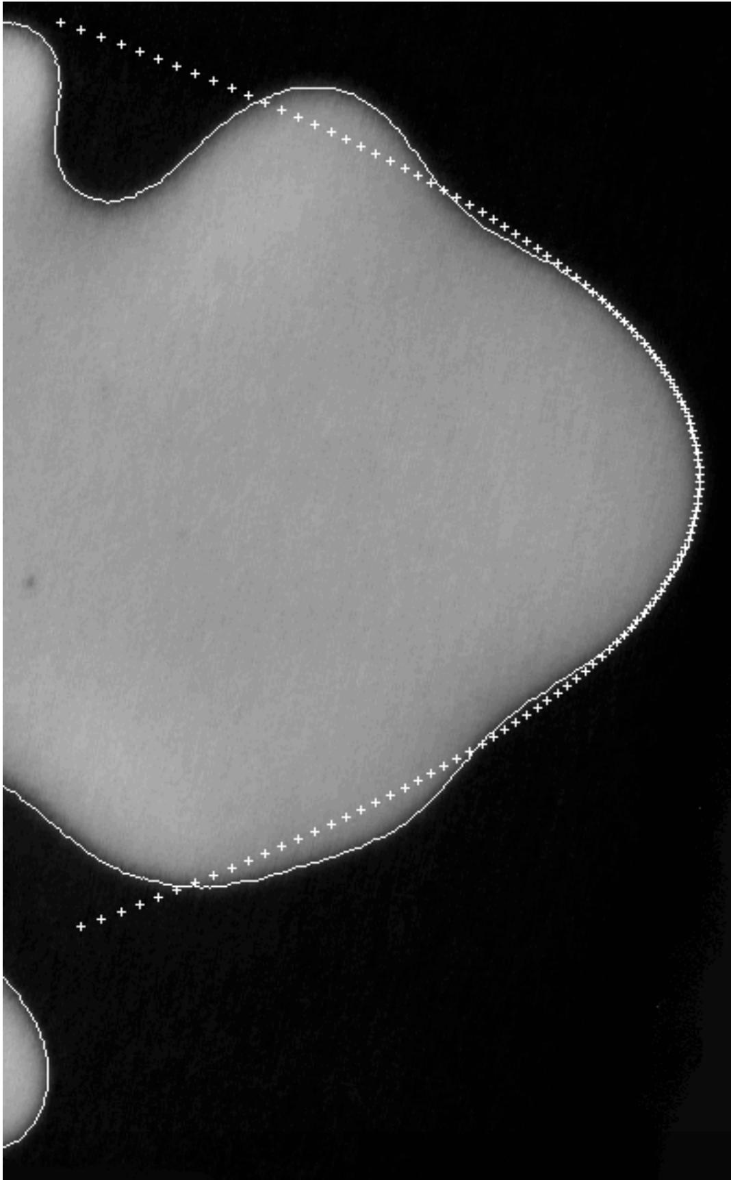
Fig. III16 Interpolation de la pointe d'une dendrite par une parabole ( $\rho = 29 \mu\text{m}$  )
