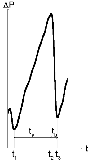
FIG. 8.2 – Montée en pression suivie de l'émission d'une bulle : h = 11\text{cm} , s = 2,5\text{cm} , 37 < r < 75\mu\text{m} , d = 1\text{mm} , V = 105\text{cm}^3 , D = 0,8\text{mg/s}
