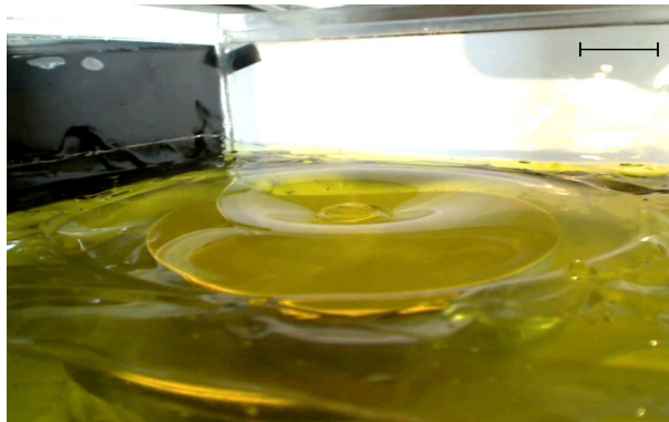
FIGURE 2.3: Profil d'un des principaux comportements de la surface libre observés lors de notre étude : "la calotte négative". Ce profil a été obtenu avec h = 2.5\text{cm} , C = 45\% et f = 4.0\text{Hz} . Cette valeur de fréquence a été atteinte par valeurs inférieures. Le trait représente 2cm.
