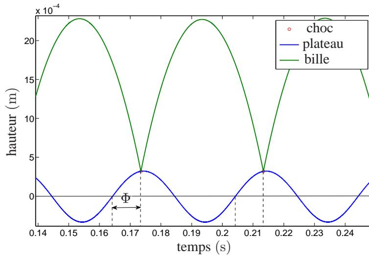
FIGURE 7 – Reconstitution de la trajectoire de la bille en mode 1, après mesure des hauteurs et des instants de chocs
