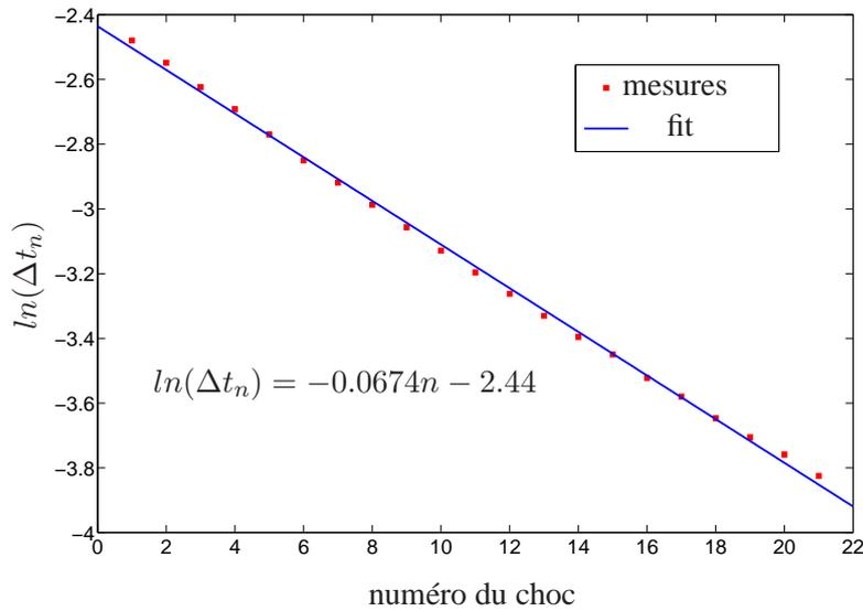
FIGURE 6 – Détermination du coefficient de restitution en vitesse par loi de choc locale
