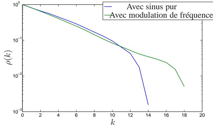
FIGURE 19 – Auto-corrélations comparées de l’énergie de la bille acquise après un choc (échelle logarithmique)
