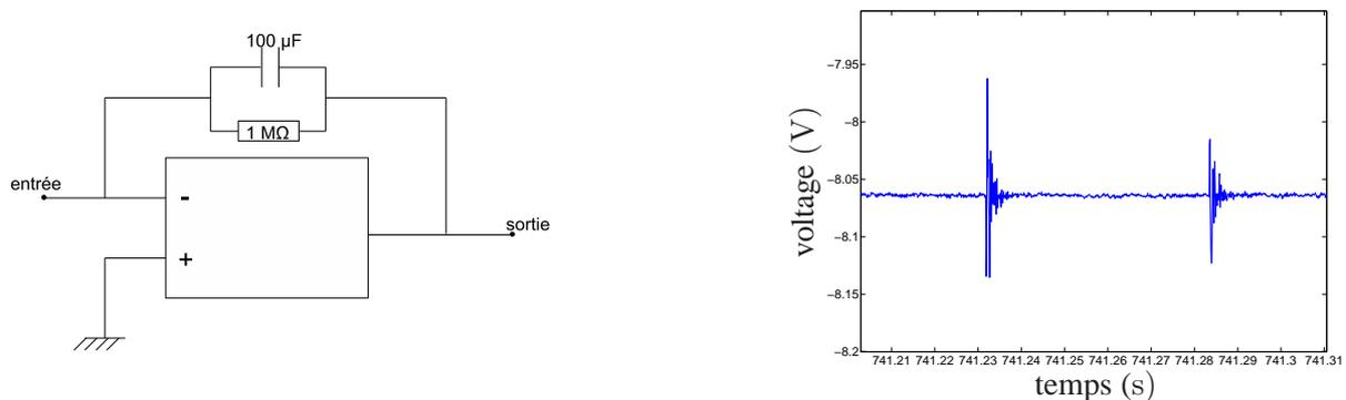
FIGURE 2 – Montage électrique amplificateur couplé au micro et signal délivré par le montage. Les pics observés sur le signal correspondent à des chocs de la bille sur le plateau.
