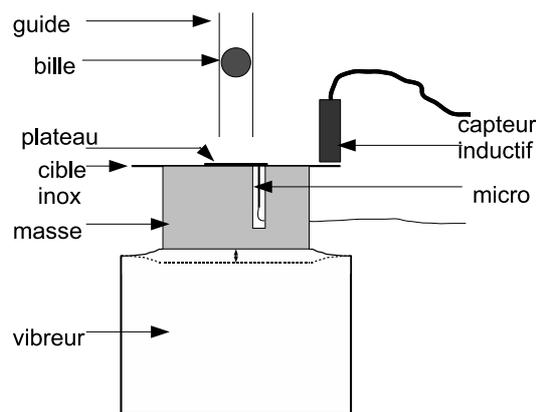
FIGURE 1 – Schéma du montage expérimental vu de côté (pas à l'échelle)
