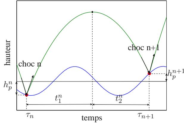
FIGURE 3 – Schéma représentatif de la trajectoire de la bille
