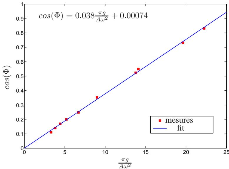
FIGURE 8 – Cosinus de la phase  $\Phi$  en fonction de l’inverse de l’accélération relative  $\frac{\pi}{T}$
