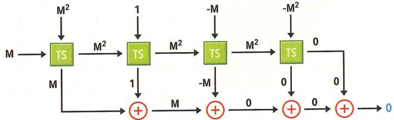
Si on utilise TwoSum pour réaliser chaque addition (ligne du haut), et que l'on additionne parallèlement entre eux les écarts (lignes du bas) pour corriger l'erreur, on obtient encore 0, comme dans l'addition machine.
