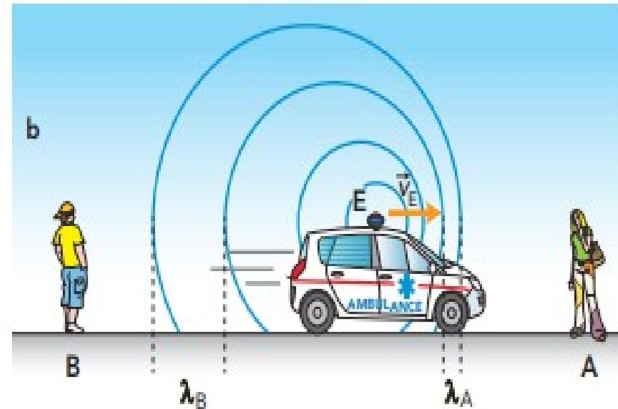
**Doc. 14** Lorsque l'émetteur se déplace à la vitesse  $v_E$  en s'approchant de l'observateur A et en s'éloignant de l'observateur B, ceux-ci perçoivent des ondes de longueurs d'onde  $\lambda_A < \lambda$  et  $\lambda_B > \lambda$ .
