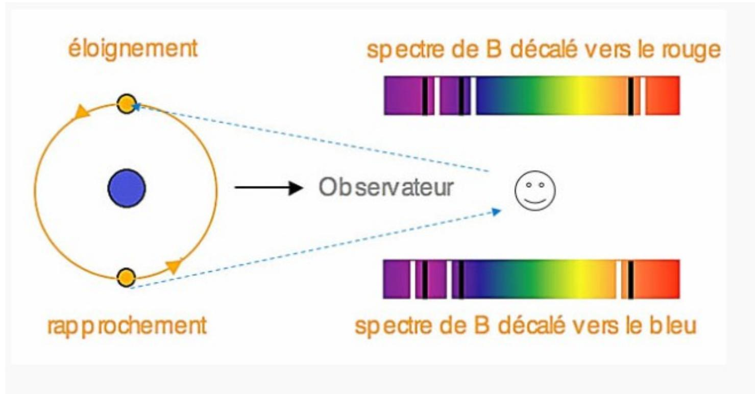
Quand la source **se rapproche** du récepteur la fréquence reçue augmente : **son plus aigu**
