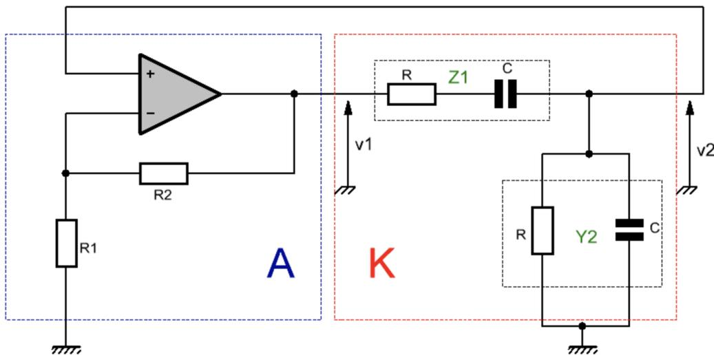
On retrouve bien les éléments d'un oscillateur quasi-sinusoïdal :
