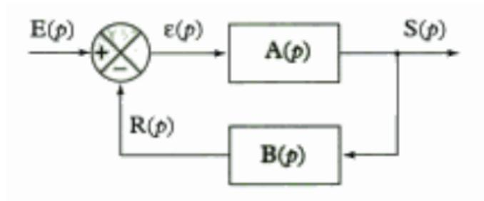
Comme on l'a déjà vu, un moyen intelligent de déterminer le comportement d'un système électronique est de calculer sa fonction de transfert, ici définie par :
