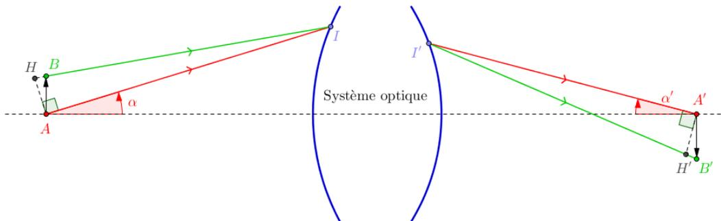
FIGURE 6 – Schéma pour démo condition d'Abbe. wikipedia
