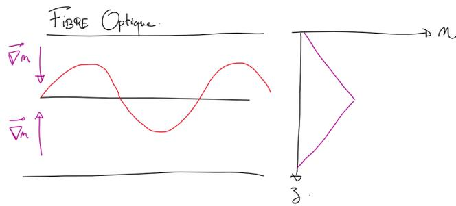
FIGURE 10 – fibre optique à gradient d'indice
