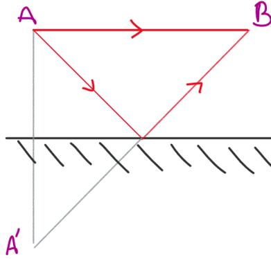
FIGURE 2 – Réflexion sur un miroir : le trajet des rayons n'est pas forcément le plus court!
