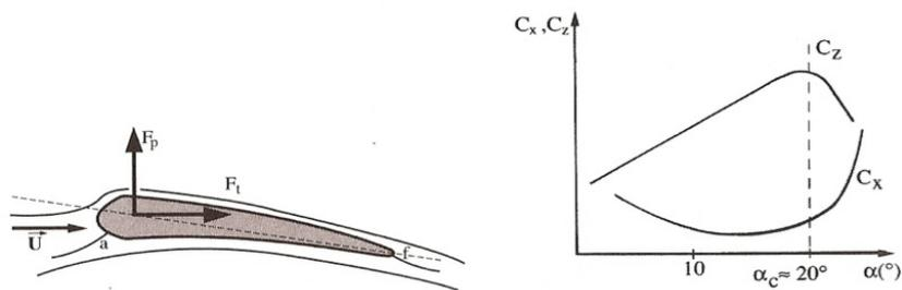
FIGURE 7.8 – À gauche, une vue schématique de l'écoulement autour d'une aile, et des forces de portance et de traînée.  $a$  et  $f$  sont les bords d'attaque et de fuite. À droite, la variation des coefficients de portance  $C_z$  et de traînée  $C_x$  en fonction de l'angle d'incidence  $\alpha$ .
