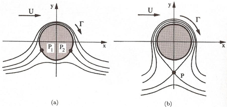
FIGURE 5.3 – *Forme des lignes de courant autour d'un cylindre circulaire placé dans un écoulement uniforme à l'infini. Cas où la circulation  $\Gamma$  de la vitesse autour du cylindre est non nulle (négative dans le cas de la figure); (a) :  $0 < |\Gamma| < 4\pi R|U|$ ; (b)  $|\Gamma| > 4\pi R|U|$*
