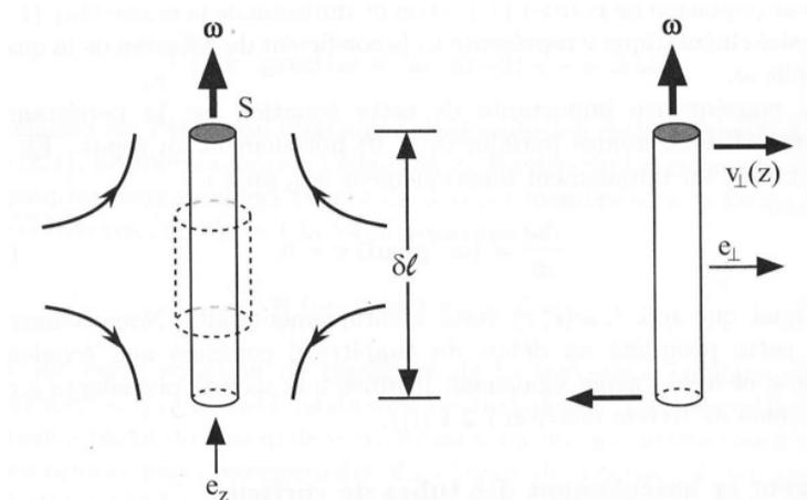
FIGURE 4.5 –   gauche la variation de la vorticit   $\boldsymbol{\omega}$  associ    la d formation d'un tube de vorticit  par  tirement.   droite la variation de  $\boldsymbol{\omega}$  par basculement d'un tube de vorticit .
