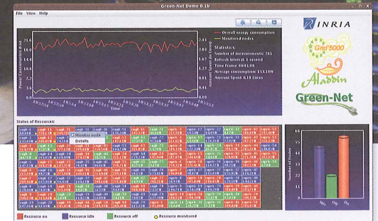
Le logiciel de visualisation ShowWatts, développé dans l'équipe Reso, permet de contrôler la consommation électrique des nœuds de calculs et de communications d'une partie de la grille de calcul expérimentale Grid'5000.
