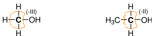
FIGURE 1.1 – Degrés d'oxydation en chimie organique : comparaison des atomes fonctionnels du méthanol et de l'éthanol.
