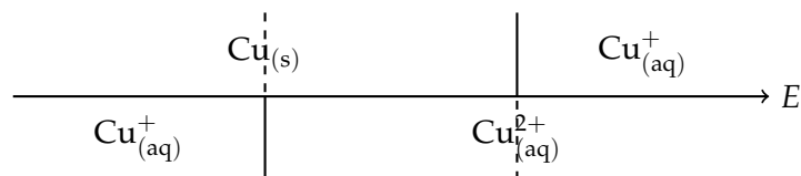
FIGURE 2.2 – Exemple de la dismutation du cuivre. Les domaines de prédominances du cuivre (I) en tant qu'oxydant et réducteur sont disjoints, si bien que le cuivre (I) n'est pas stable thermodynamiquement.
