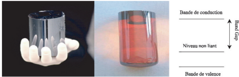
Figure 10 : Blocs de verres de séléniure (à gauche) et de sulfure (au centre). Le niveau électronique non liant dû aux doublets électroniques présents sur S et Se vient s'intercaler entre les niveaux liants (bande de valence) et antiliants (bande de conduction). La bande d'énergies interdites (« band gap ») est alors réduite, de l'ordre de 2 eV, limitant la transmission dans le visible : les verres de chalcogénures sont souvent noirs, seuls certains sulfures sont rouges voir jaunes.
