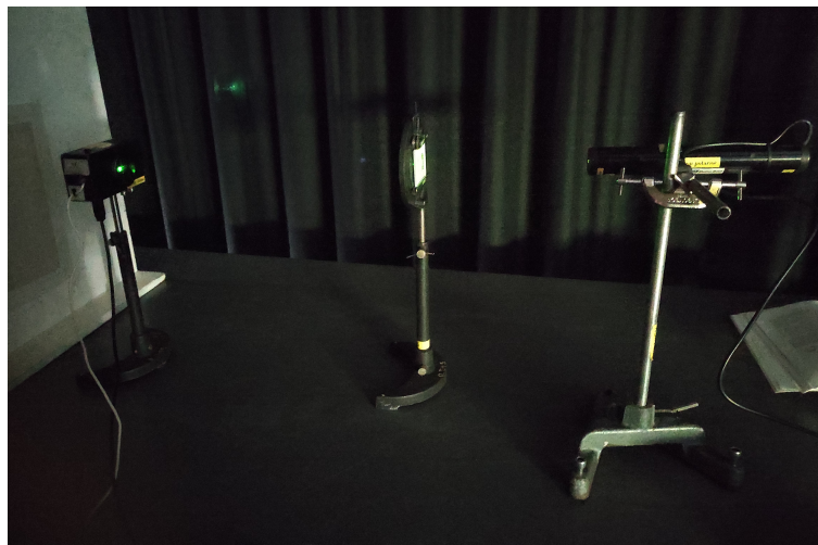
FIGURE 10 – Montage diffraction avec capteur CCD
