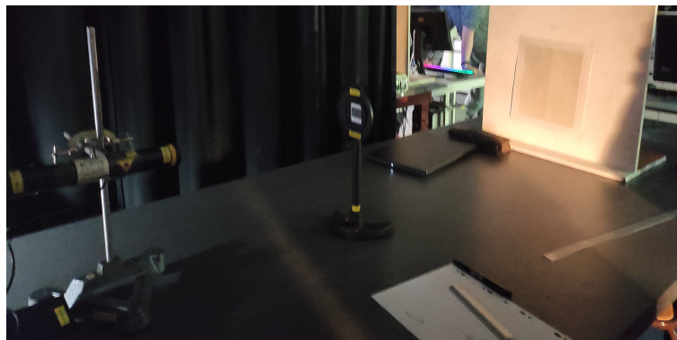
FIGURE 6 – Mesure épaisseur cheveux grâce à diffraction
