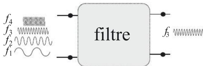
**Figure 1** – Représentation schématique d'un filtre (Source : Côte (p. 472)).
