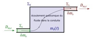
Pour cela, on suit une portion de fluide (système fermé) contenue dans les volumes  $\Sigma_e$  et  $\Sigma_0$  au temps initial t et en  $\Sigma_0$  et  $\Sigma_s$  au temps  $t+\mathrm{d}t$ .  $\Sigma_0$  est appelé **volume de contrôle** car il est invariant entre les deux temps.
