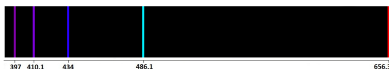
Figure 7 – Spectre d'émission de la lampe à vapeur d'hydrogène ( Source : web-labosims.org ).
