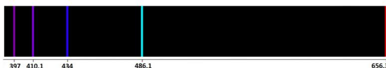
**Figure 9** – Spectre d'émission de la lampe à vapeur d'hydrogène (Source : web-labosims.org).
