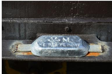
Figure 6 – Anode sacrificielle sur un bateau (Source : *Wikipédia*).
