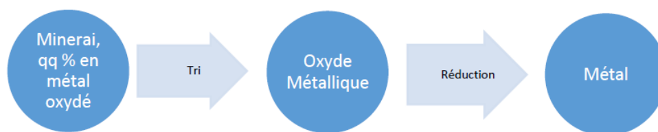
FIGURE 1 – Schéma représentant les différentes étapes de l'obtention des métaux. Ce schéma, comme le reste de la leçon, a été pris dans la leçon de Thibaut Clarté.
