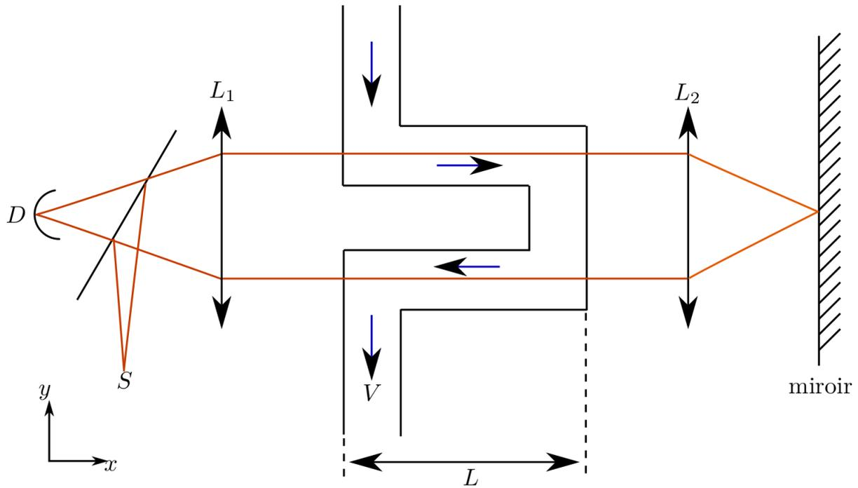
Figure 7: Principe de l'expérience de Fizeau. L'eau circule à la vitesse  $V$  relativement au référentiel du laboratoire. Les faisceaux sont émis par une source  $S$ , séparés par un miroir semi-réfléchissant puis arrivent au détecteur  $D$  après un aller-retour à travers les deux bras du circuit hydraulique.
