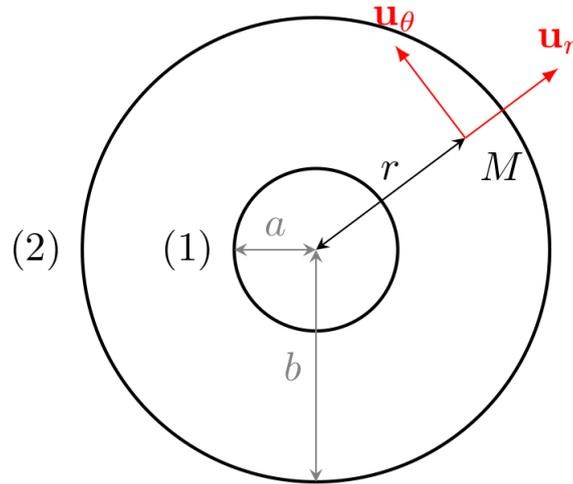
Figure 4: Schéma en coupe d'un câble coaxial.  $(Oz)$  est orienté vers nous. Figure issue du poly de Clément Cabart
