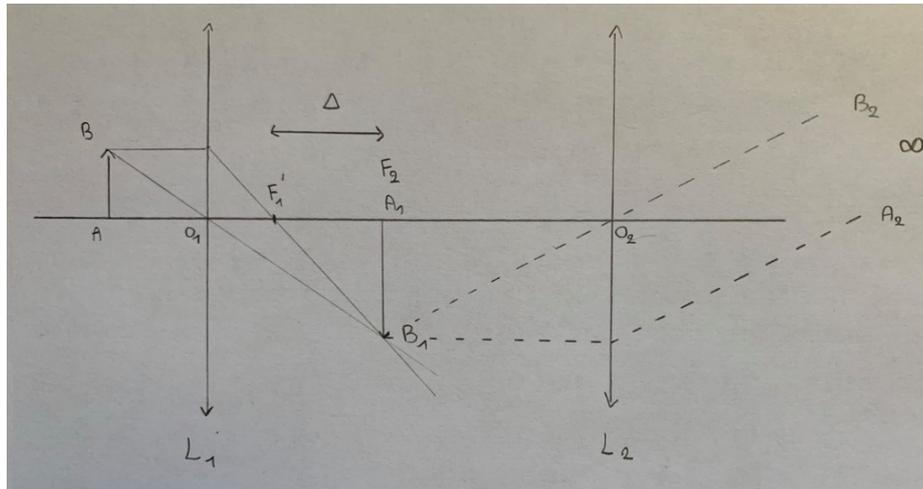
FIGURE 1 – Schéma d'un microscope à deux lentilles
