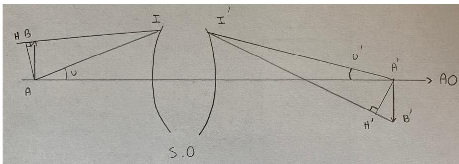
FIGURE 2 – Schéma permettant de démontrer la relation d'Abbe.
