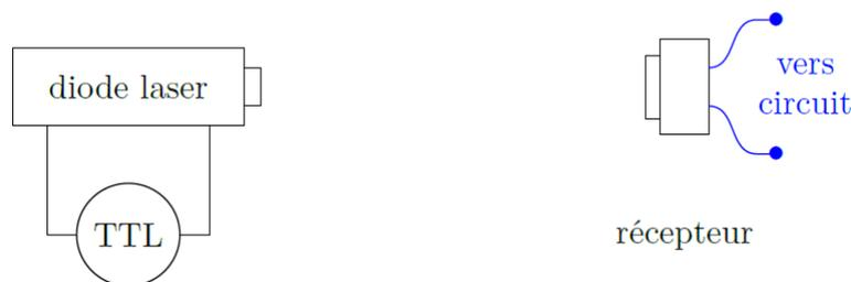
FIGURE 6 – Montage permettant l'étude de la réponse dynamique de la photodiode. Cette figure est prise du poly de Jérémy Ferrand.
