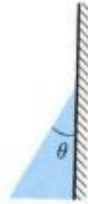
Figure 2 – Angle de contact. L'angle de contact \theta   une interface air-liquide-solide. Le liquide est repr sent  en bleu, le solide en hachur .
