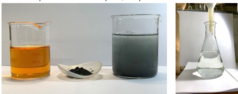
Photo de gauche : solution de diiode, poudre de zinc et leur mélange. À droite, filtrat incolore.
