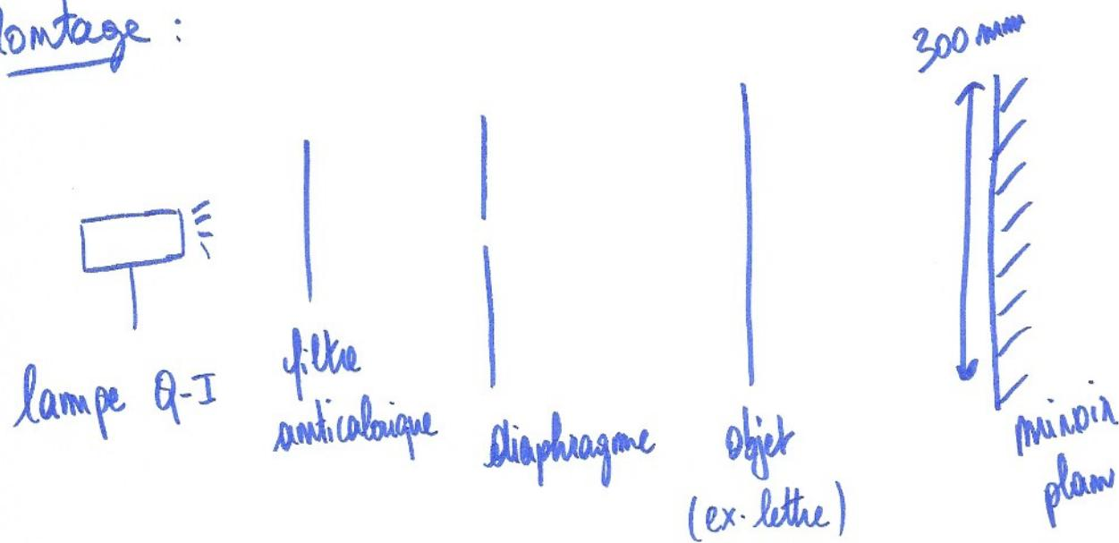
On bouge la lentille et le miroir jusqu'à former l'image nette de l'objet dans le plan de ce dernier.
