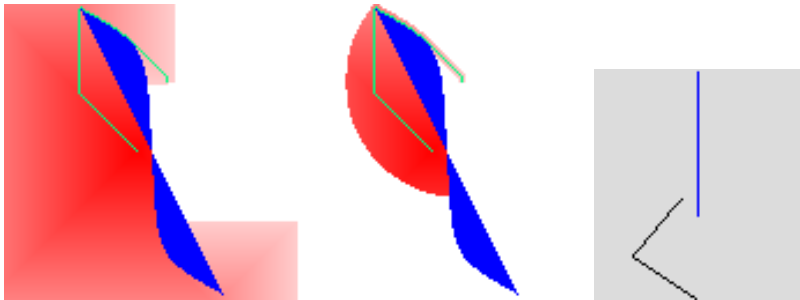
Figure – Recherche par algorithmes de Dijkstra et A* pour une discrétisation naïve ( d = 2 ) des configurations d'un bras robotique.
