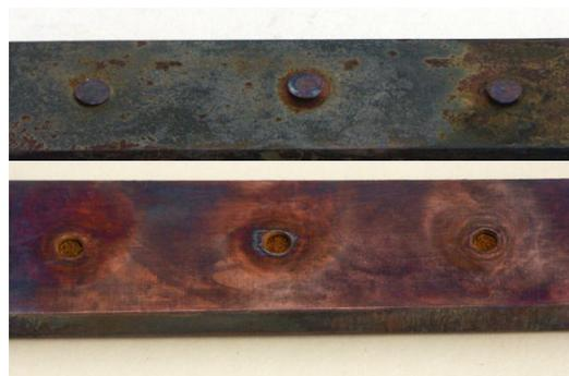
Figure 46 – Diagramme d'Evans pour des surfaces différentes : plus la différence de surface est grande, plus le courant de corrosion est élevé (augmentation de la surface de la cathode). À droite, deux systèmes, l'un ou les rivets sont en fer dans une plaque de cuivre, l'autre ou les rivets sont en cuivre dans une plaque de fer.
