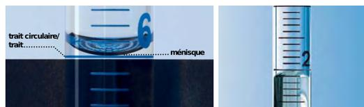
**Figure 3.1** – Dans le cas d'un ménisque concave (à gauche, cas le plus courant) le volume indiqué correspond au bas du ménisque. À droite, dans le cas d'un ménisque convexe, c'est le haut qui sert de référence.
