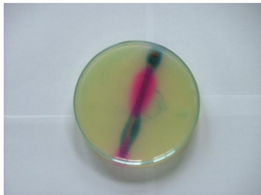
Le rose est dû au virage de la phénolphthaléïne dans les zones où  $OH^-$  apparaît. Le bleu est dû à la formation d'hexacyanoferrate de fer  $Fe_3[Fe(CN)_6]_2$  dans les zones où  $Fe^{2+}$  apparaît.
