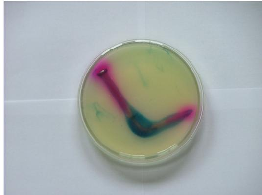
L'oxydation du fer se fait sur la zone ayant subi la déformation, la réduction de l'eau (ou du dioxygène) se fait sur le reste du clou.
