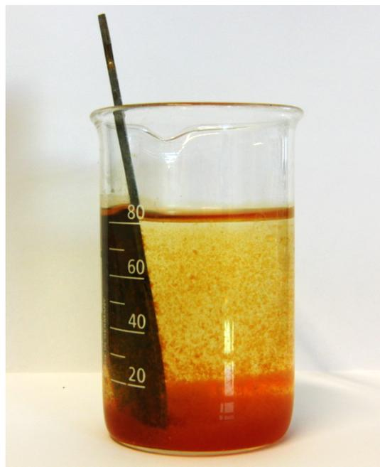
La réaction bilan de la corrosion est une réaction d'oxydation du métal par l'eau. Cependant, cette réaction ne se fait pas directement. Il y a sur la surface du métal deux réactions électrochimiques distinctes. Le transfert d'électrons se fait par le métal et non directement entre l'atome métallique et l'espèce oxydante (eau ou dioxygène).
