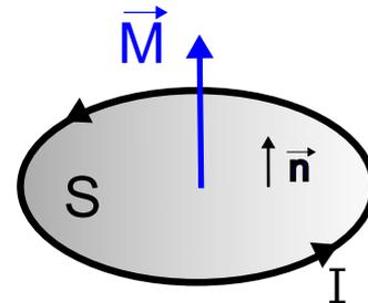
FIGURE 1 – Spire magnétique, surface orientée et moment
