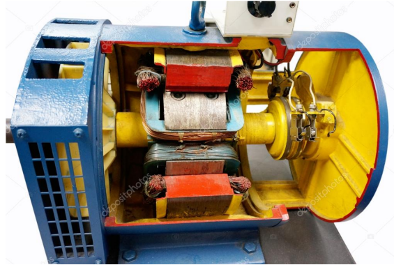
FIGURE 12 – Coupe d'une machine synchrone. On distingue en particulier deux des trois bobines qui créent le champ statorique (coupées), et le rotor alimenté en courant continu par deux bagues sur la droite.
