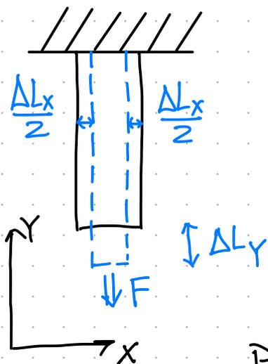
Tout solide est au moins partiellement incompressible. S'il s'allonge dans une direction, il a tendance à se contracter dans les autres directions
