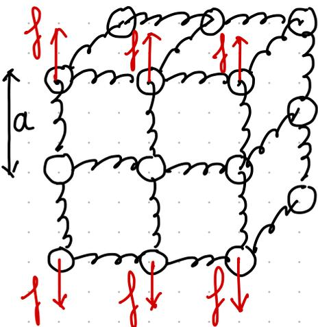
On assimile un cristal à un réseau cubique simple, soumis à une force  $f$  par atome de surface
