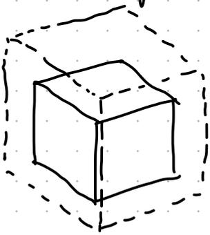
La dilatation thermique induit une déformation isotrope.
