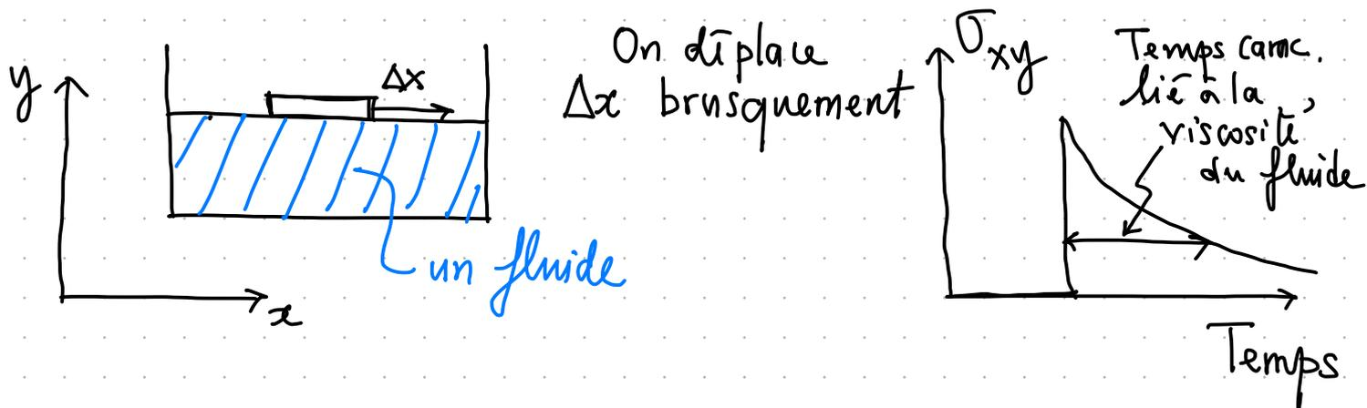
⇒ Pour induire une contrainte de cisaillement dans un fluide, il faut cisailier continuellement et imposer une vitesse de cisaillement :
