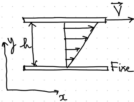
la plaque supérieure se déplace à la vitesse  $V$  et entraîne le fluide :
