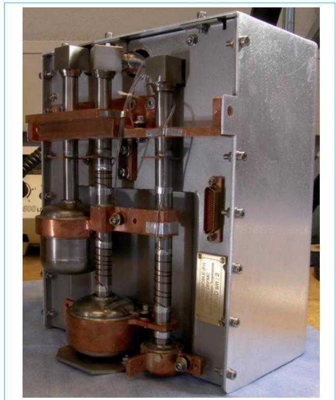
Figure 8 – Système tri-étagé 240 mK installé sur l'expérience BICEP2/KECK pour le refroidissement de bolomètres, pour la détection des ondes gravitationnelles (Base Amundsen-Scott – Antarctique) (doc. INAC/SBT CEA Grenoble)
