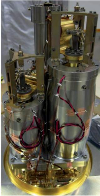
**Figure 15 – Modèle de vol de l'ADR 50 mK multiétagées (mission ASTRO-H)** (doc. P. Shirron, NASA Goddard)
