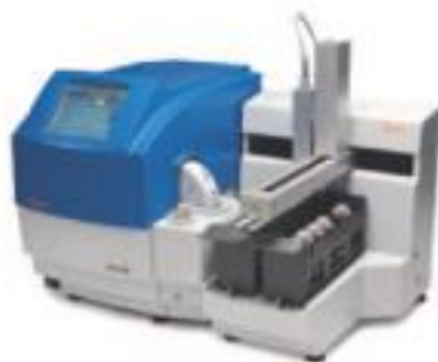
(a) monomode (BIOTAGE Initiator EXP 60) pour la synthèse à l'échelle du laboratoire (image reproduite avec la permission de la société BIOTAGE, http://www.biotage.com )
