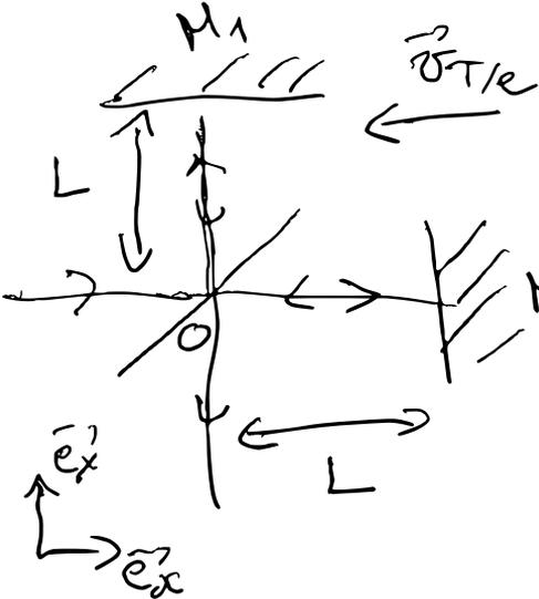
Si la Terre est en mouvement dans l'éther, la vitesse de la lumière n'est pas la même dans les deux bras de l'interf.
