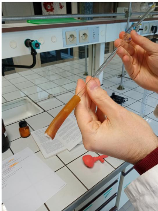
FIGURE 3 – Dispositif pour pipeter sans prendre de solide en suspension
