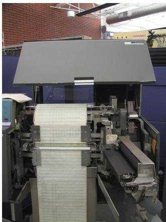
FIGURE 4 – Une imprimante à tambour, capot ouvert. *Source Wikimedia Commons.*
