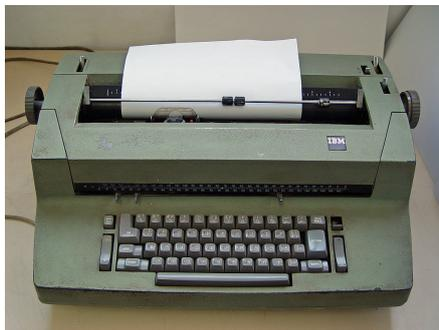
FIGURE 7 – Une machine à écrire IBM à boule. *Etan J. Tal via Wikimedia Commons.*
