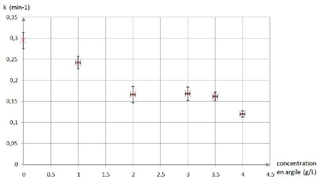
Figure 9 : Evolution de la valeur de k en fonction de la concentration en argile
