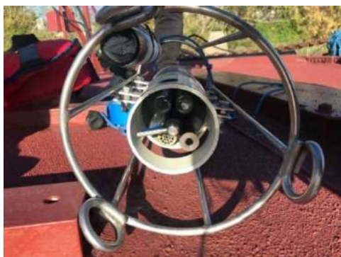
Photos 1 et 2 : Sondes à oxygène utilisées pendant les mesures (photo de gauche) et prise de mesure (photo de droite)
