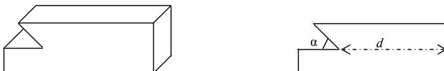
Pour déterminer  $d$ , on place une pige de diamètre  $w$  dans la rainure et on mesure une distance  $L$
