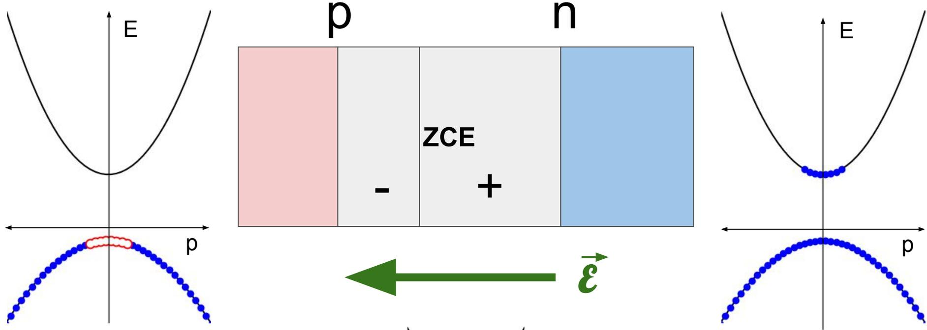
Remplissage des couches de valence et de conduction dans les parties neutres (p et n) et la Zone de Charge d'Espace de la Jonction PN.
