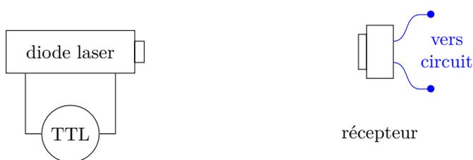
**Figure 5 – Schéma de l'expérience.** Une diode laser commandée par un générateur de signal TTL éclaire un photorécepteur. La grandeur photosensible du photorécepteur est mesurée à l'oscilloscope via un circuit électronique.
