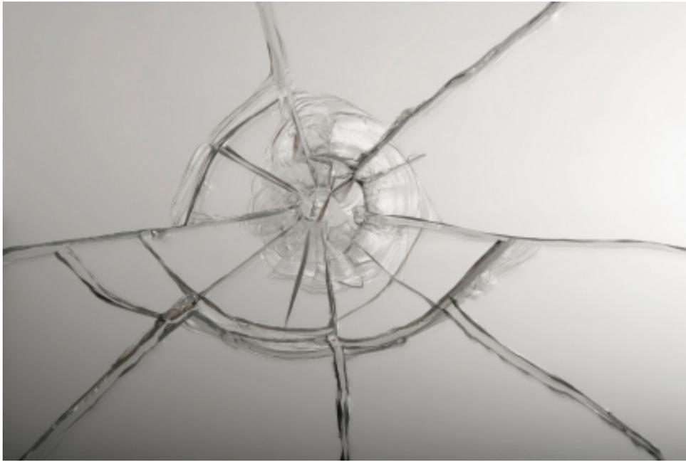
FIGURE 2 – Fracture due à un impact sur le verre d'un pare brise. Taille typique : de 1 à 10 cm.
