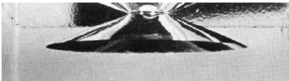
FIGURE 2.1 – Photographie d'une fracture par indentation d'une bille dans du verre. Image tirée de la littérature [66].
